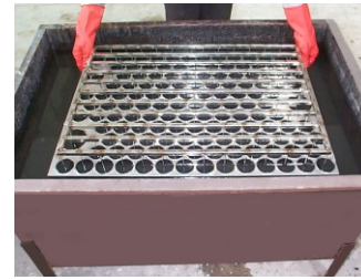
Figure 4-4 Mergulhe as células de favo de mel
