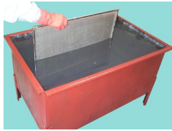
Figure 4-3 Mergulhe o divisor de fluxo de ar
