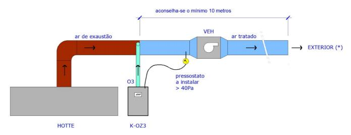
Tipo 3 – Instalação com filtro eletrostático (exaustões exigentes)
